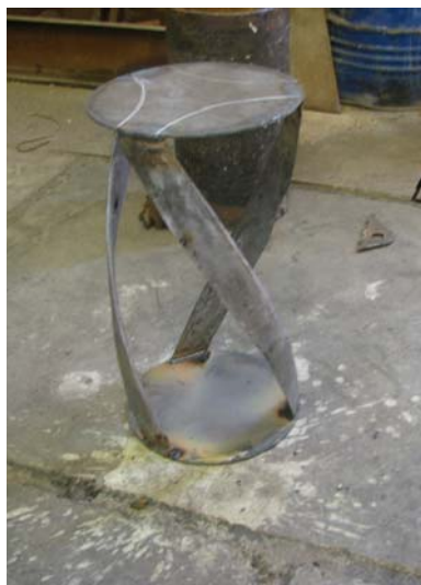
شکل ۲: روش نصب پره های توربین تورآب بر روی بدنه توربین
