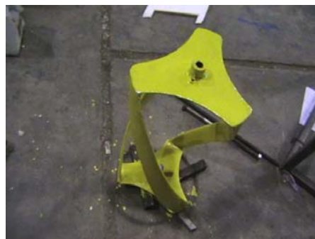
شکل ۳: اتمام کار ساخت و رنگ آمیزی توربین تورآب
