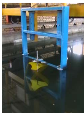
شکل ۶: نصب توربین بر روی کانال هیدرودینامیک
