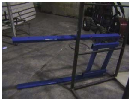
شکل ۴: اتمام کار ساخت و رنگ آمیزی اسکلت و رابط
