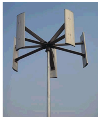
شکل ۲. توربین بادی محور عمودی H شکل.
