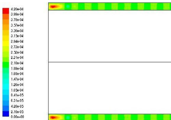
شکل (۳)- کانتورهای تابع جریان- جریان پایدار ( Ta = 500 ).
