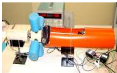
شکل (۲): توربین مورد آزمایش با ۴ استوانه چرخان بعنوان پره
